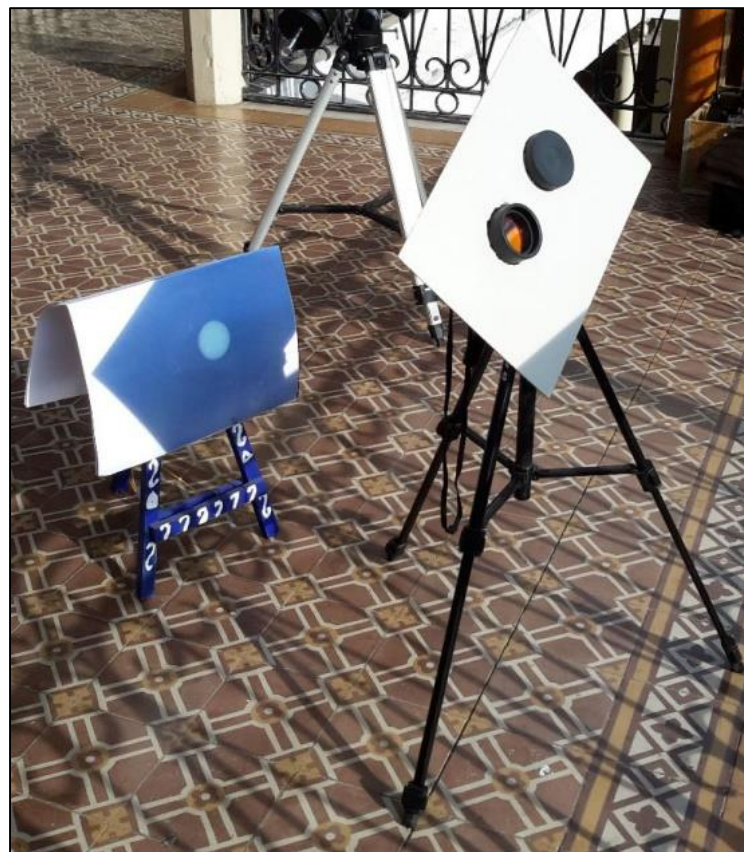
Figura 22. Prismático montado en un trípode dispuesto para proyectar la imagen del Sol, en oportunidad del tránsito de Mercurio del 9 de mayo de 2016.
