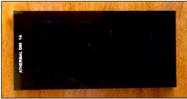
Figura 13. Los “vidrios” o filtros de soldador están fabricados en vidrio, con un tamaño de unos 100 x 50 mm y 2 a 3 mm de espesor. En uno de sus bordes se indica el nivel de absorción expresada por un número de las normas alemanas DIN. El adecuado para observar el Sol es el N°14.
