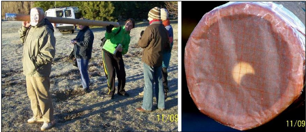
Figura 21. La fotografía muestra cómo se utiliza la cámara oscura con forma de tubo, y la imagen del Sol formada en la pantalla de “papel manteca” (o milimetrado transparente). ( Plaza del Cielo )
